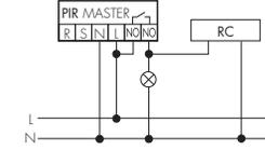
Per la commutazione con lampade fluorescenti, ecc. è eventualmente necessario l'uso di un circuito RC.
