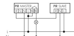
Aumento del campo d'azione con l'impiego di uno o più apparecchi Slave. Attenzione: L'apparecchio Master deve essere sempre montato in un posto dove la luce del giorno è minima.
